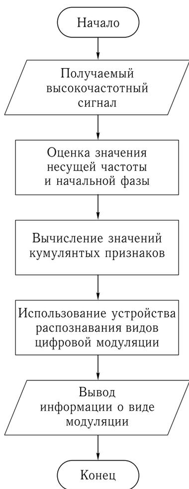
Рис. 6. Блок-схема алгоритма распознавания видов цифровой модуляции в условиях априорной неопределенности
