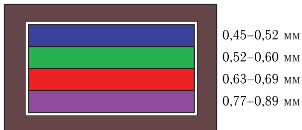
Рис. 2. Расположение спектральных фильтров на ФПУ и их полосы пропускания
