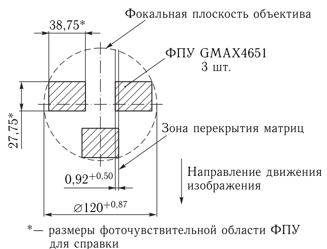
Рис. 1. Вариант установки матриц в фокальной плоскости объектива
