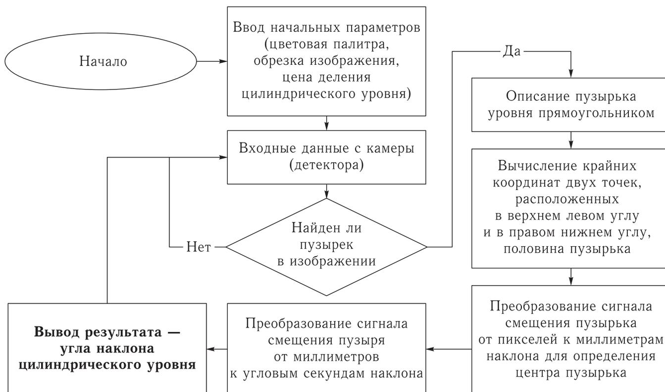
Рис. 3. Алгоритм определения углов наклона при помощи ВИМ
