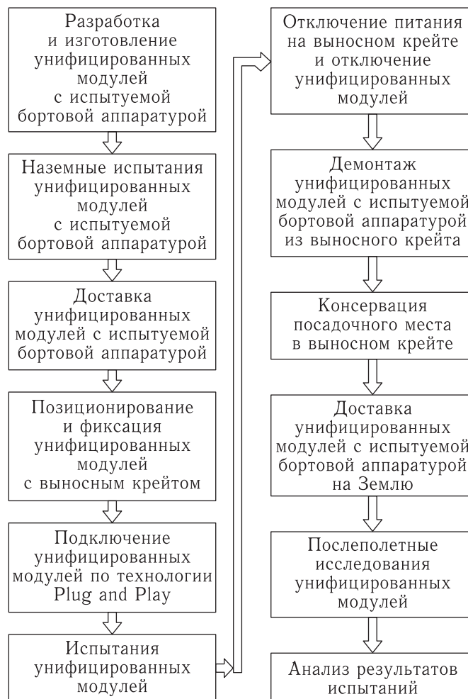
Рис. 5. Блок-схема последовательности подготовки и проведения предварительных натурных испытаний бортовой аппаратуры космического назначения
