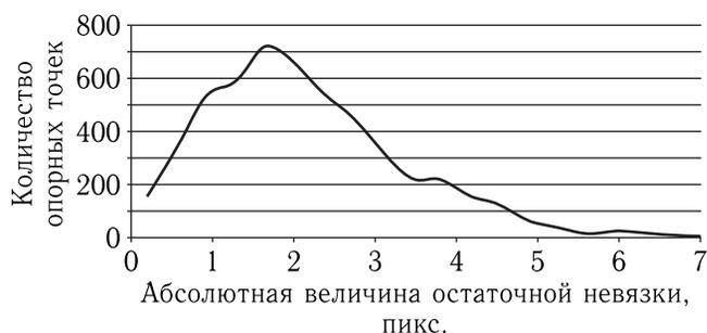
Рис. 6. Распределение количества опорных точек в зависимости от величины абсолютной невязки по результатам фотограмметрического уравнивания маршрута съемки КМСС КА «Метеор-М» № 2 (виток — 37 251, камера — 201)
