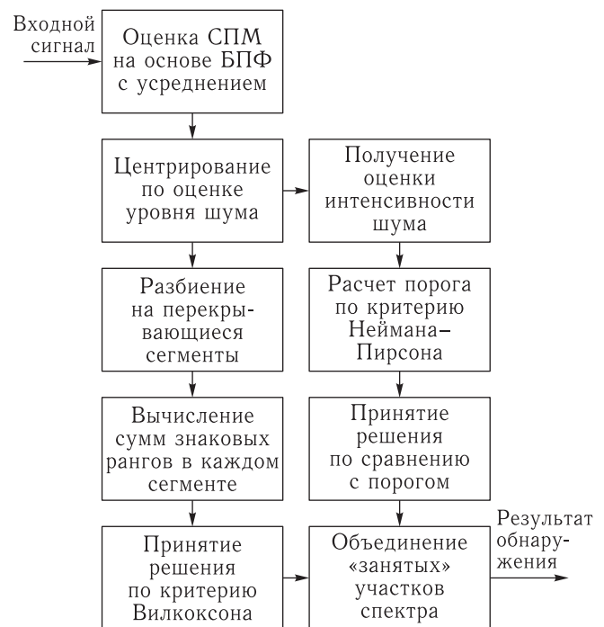
Рис. 2. Функциональная схема комбинированного алгоритма обнаружения радиосигналов
