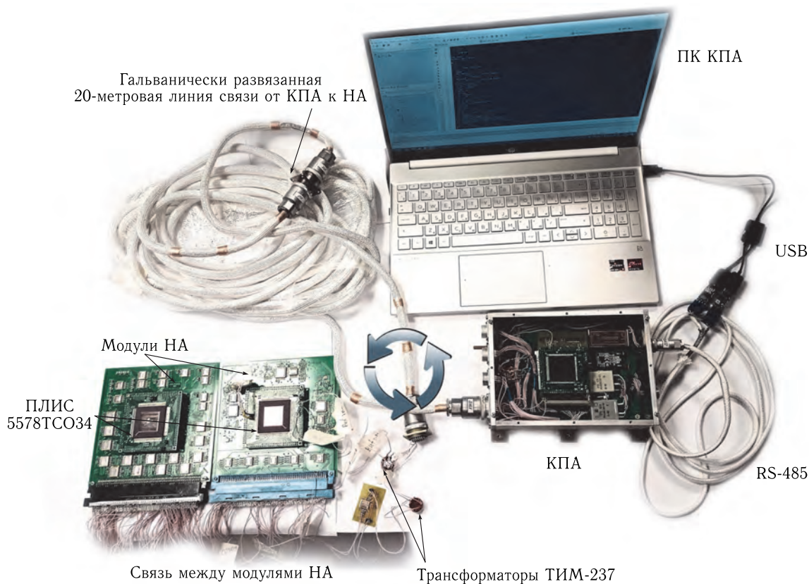
Рис. 4. Научная аппаратура, использующая пакеты «infinite loop» для соединения между модулями и блоком КПА
