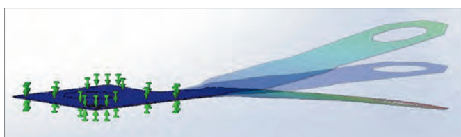
Рис. 3. Первая мода собственных колебаний экранирующего электрода МС
