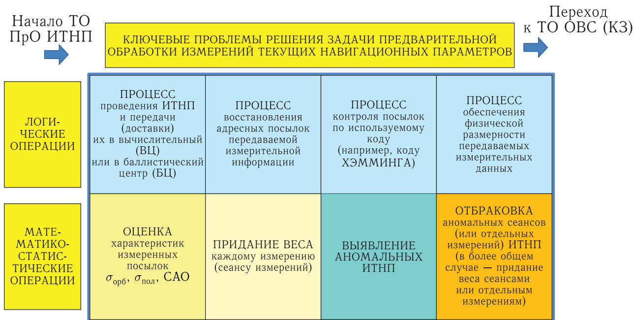
Рис. 1. Матрица проблем решения задач типовой технологической операции (предварительной обработки измерений) управления КА
