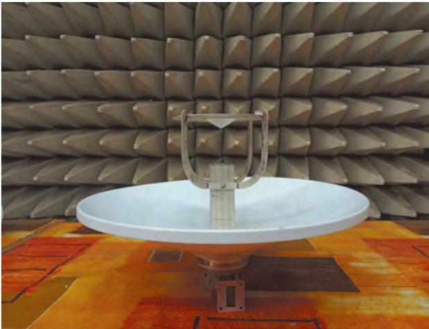
Рис. 1. Конструкция зеркальной антенны с облучателем
