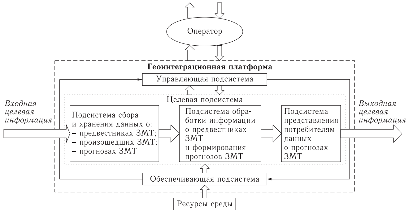
Рис. 1. Функциональная структура макета информационного сервиса мониторинга и краткосрочного прогнозирования сильных землетрясений
