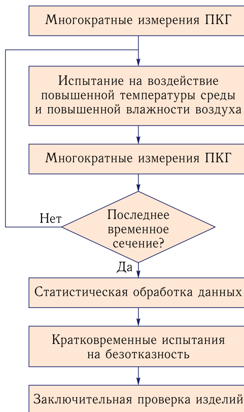
Рис. 1. Порядок проведения ускоренных испытаний на сохраняемость
