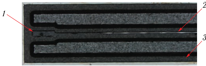
Рис. 7. Изображение локального отслоения, наблюдаемого в результате температурного воздействия при -196\text{ }^{\circ}\text{C} на СВЧ-платы с многоуровневой коммутацией на основе фотополимера с системой металлизации \text{Cr-Cu-Ni} , где 1 — место локального отслоения металлизации СВЧ-линии, 2 — сохранившийся участок металлизации СВЧ-линии, 3 — фотополимер
