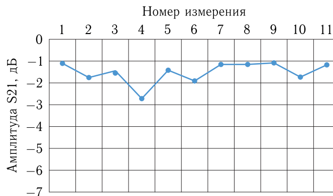
Рис. 5. Результаты измерений СВЧ-параметров многослойной структуры на основе полипиромеллитимида с системой металлизации Cr–Cu–Ni
