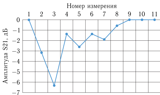
Рис. 4. Результаты измерений СВЧ-параметров платы с многоуровневой коммутацией на основе фотополимера с системой металлизации Cr–Cu–Ni после многократной термообработки
