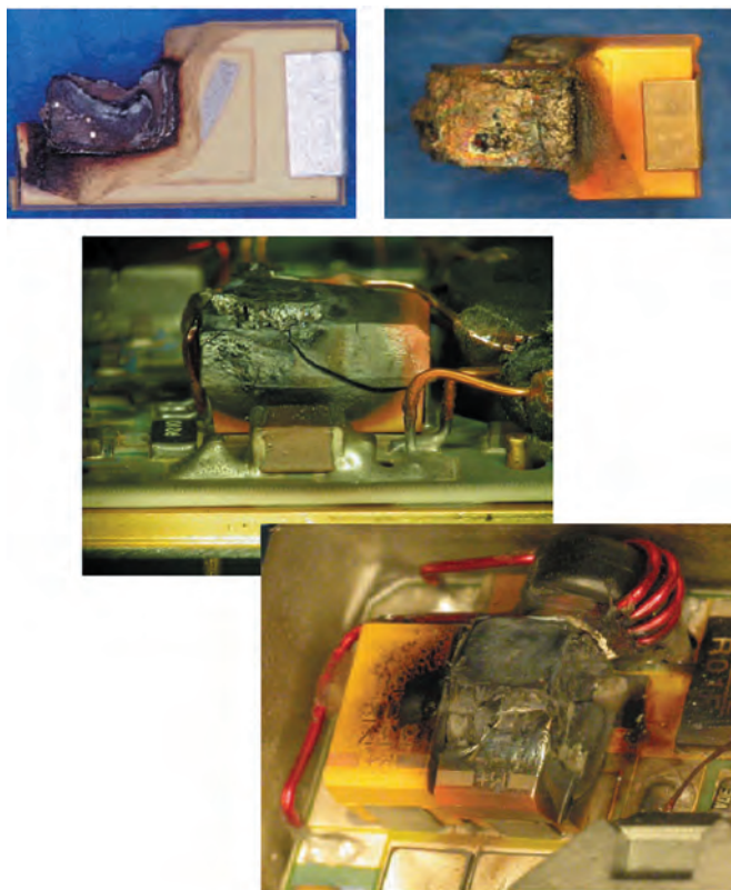
Рис. 7. Результаты катастрофического отказа танталового конденсатора [4]
