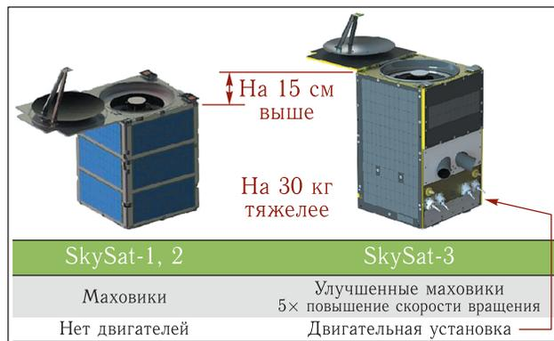
Рис. 3. Два поколения КА SkySat
