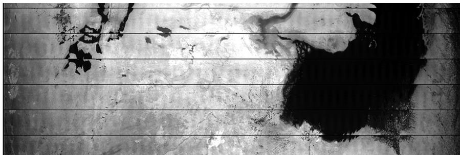
Рис. 2. Фрагмент исходного (сырого) трассового изображения с радиометра МСУ-ИК-СРМ в диапазоне 3,5–4,1 мкм
