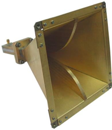
Рис. 9. Рупорная антенна
