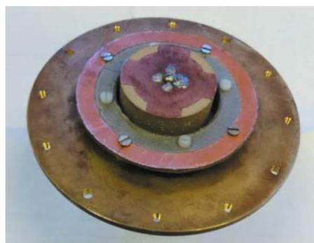
Рис. 10. Фотография макета антенны с подавлением левой поляризации
