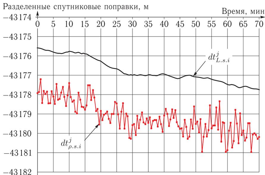
Рис. 2. Разнесенные спутниковые поправки (кодовая и фазовая) для одного из 6 НКА, вычисленные в первом варианте сетевого решения
