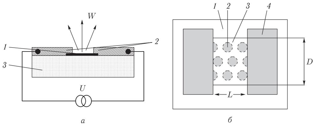
Рис. 7. Схема генератора с метапереходом: *а* — вид сбоку, *б* — вид в плане. 1 — метапереход, образованный столбиками из ферромагнитного металла (железо) — 2 и покрывающие столбики слой из FeMn — 3, 4 — контактные площадки из молибдена, 5 — диэлектрическая подложка, на которую нанесен метапереход с контактными площадками,  $W$  — мощность,  $U$  — напряжение,  $D$  — длина метаперехода,  $L$  — ширина метаперехода
