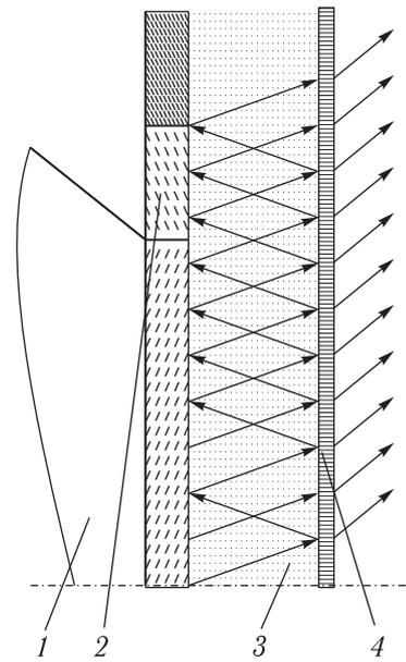
Рис. 5. Генератор стимулированного излучения. 1 — стержень, 2 — пленка, 3 — подложка, 4 — отражатель
