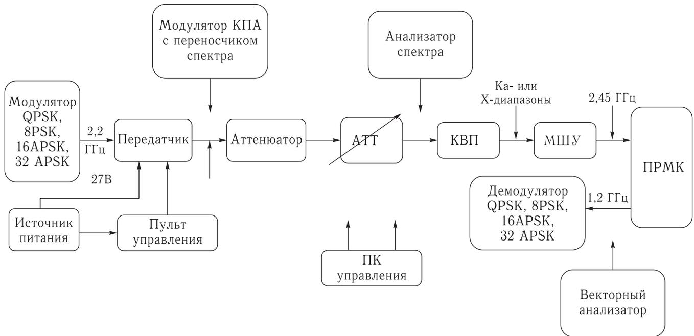
Рис. 1. Структурная схема испытательных комплексов
