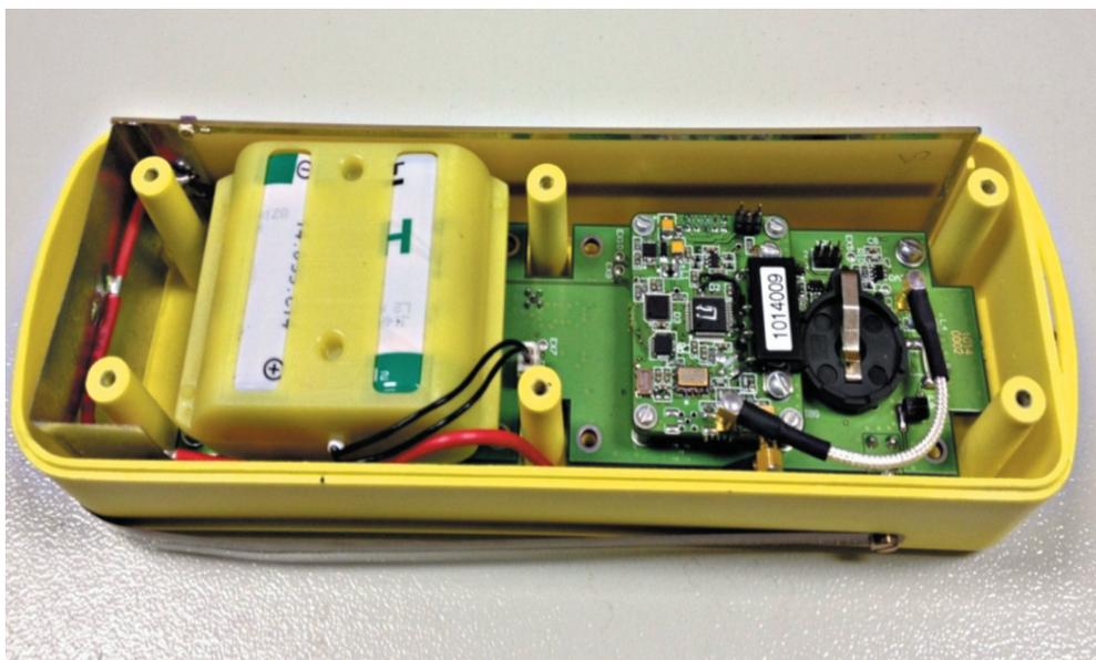
Рис. 12. Дипольно-рамочная антенна в корпусе радиомаяка
