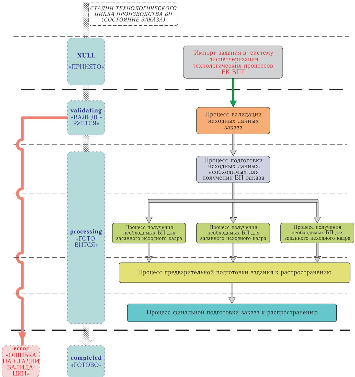
Рис. 3. Технологическая схема выполнения заказа по формированию БП ДЗЗ
