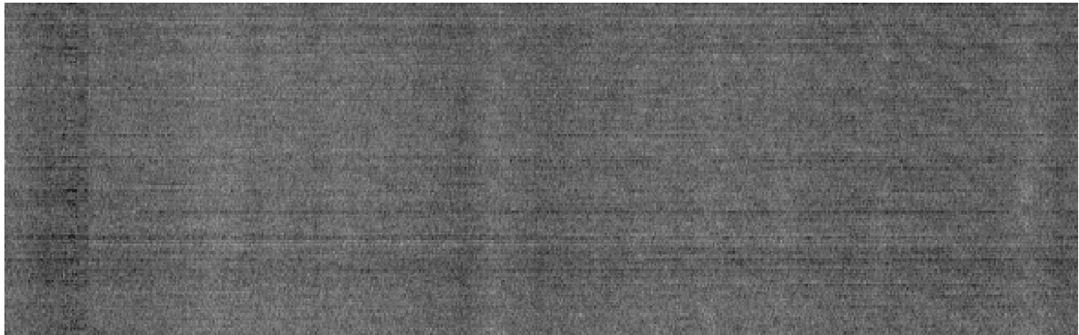
Рис. 2. Фрагмент одного из сканов ИК-канала аппаратуры МСУ-ГС № 2. Снимок получен во время съемки «фона» при наземных испытаниях. Протяженные импульсные помехи от различных ЛФПУ одного фотоприемника накладываются друг на друга при формировании выходного сигнала
