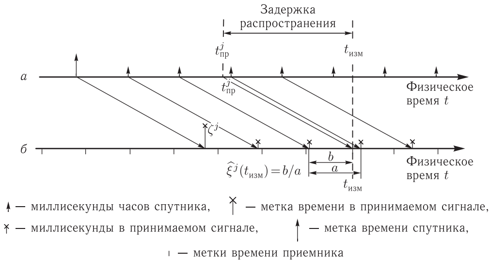
Рис. 3. Метки времени и их оцифровки в излучаемых и принимаемых сигналах ГНСС
