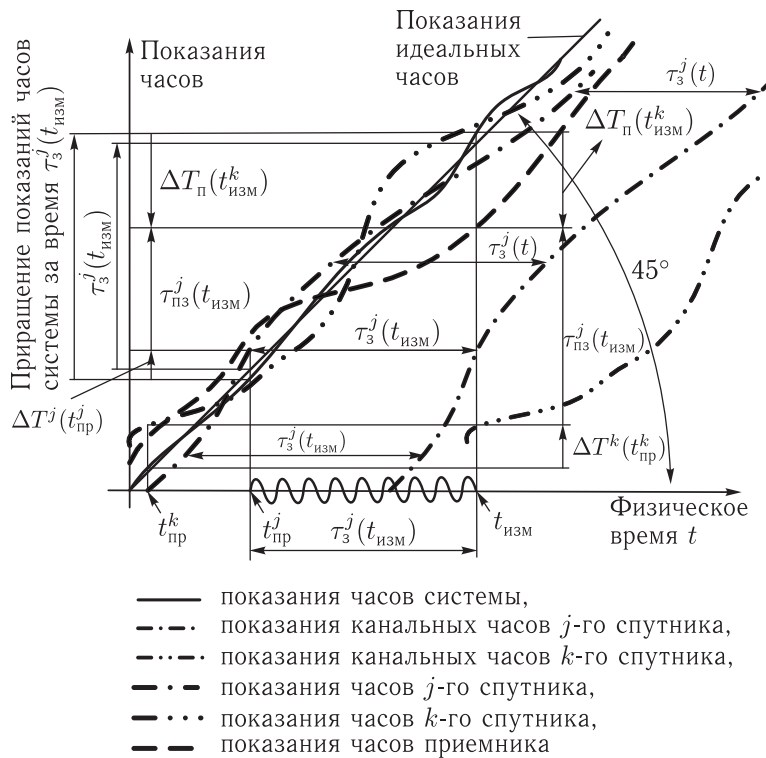
Рис. 5. Изменение псевдозадержек j -го и k -го спутников как функций физического времени t
