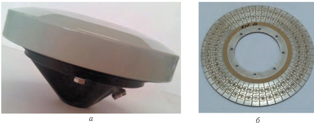
Рис. 11. Навигационный антенный модуль АСНГ-3 (размеры: ширина 180 мм, высота 93 мм) (а) и специальный EBG-метаматериал отсечки многолучевости (б)
