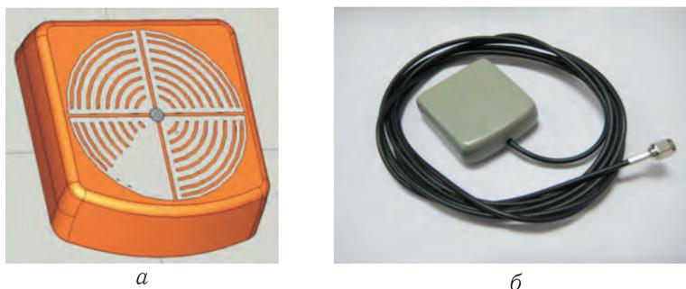
Рис. 3. Конструкция антенного элемента на основе метаматериала (а); цельнокерамический антенный модуль АСНК-3, выполненный на его базе (размеры  $30 \times 30 \times 12$  мм) (б)
