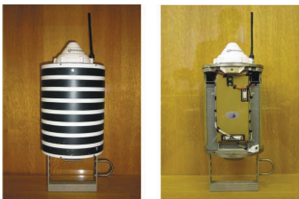
Рис. 1. ТНС-0 в собранном состоянии (слева), ТНС-0 со снятым стальным корпусом (справа)
