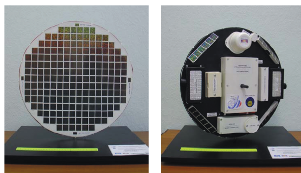
Рис. 2. ТНС-1 со стороны солнечных панелей, внешний вид (слева); ТНС-1 со стороны бортовой аппаратуры, внешний вид (справа)
