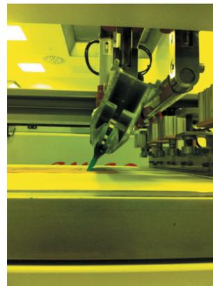
Рис. 6. Полуавтоматическая установка трафаретной печати
