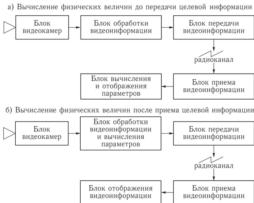
Рис. 1. Обобщенная функциональная схема системы видеотелеметрии
