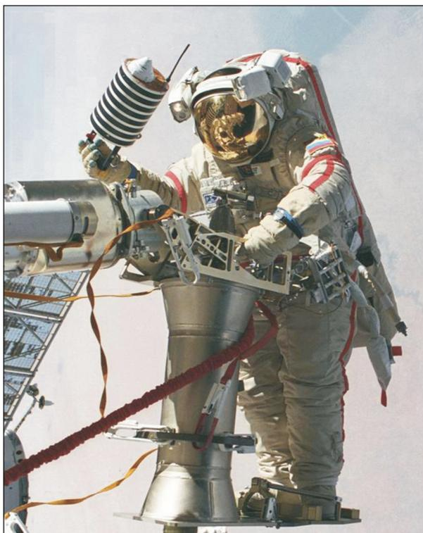
Рис. 10. Ручной запуск наноспутника космонавтом С. Шариповым
