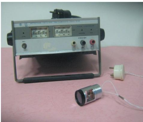
Рис. 4. Общий вид генератора с линзой и блоком питания
