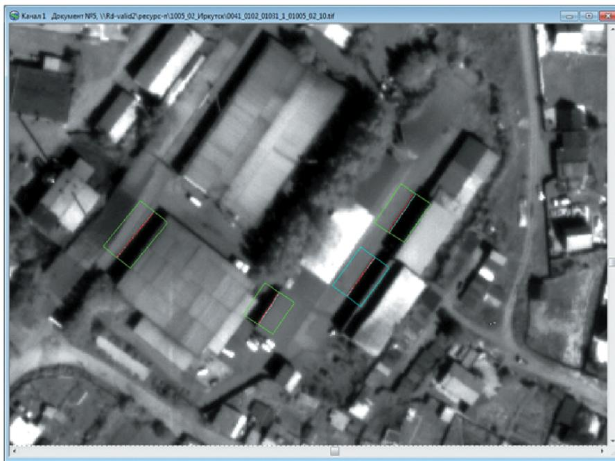
Рис. 3. Фрагмент изображения с тест-объектами типа «резкий край»
