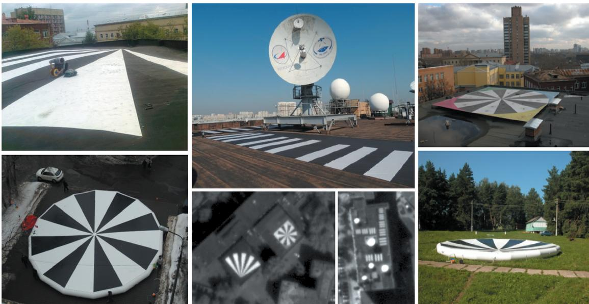
Рис. 1. Варианты изготовления тест-объектов для визуального дешифрирования
