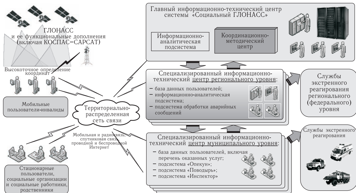
Рис. 2. Архитектура построения системы «Социальный ГЛОНАСС»
