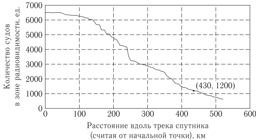
Рис. 3. График «позиция спутника–количество детектированных судов»
