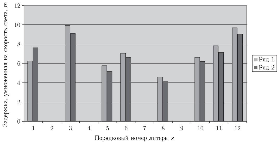
Рис. 5. Задержки \Delta\tau_{np}^s по литерам приемника, умноженные на скорость света, при использовании данных сайта -IGS
