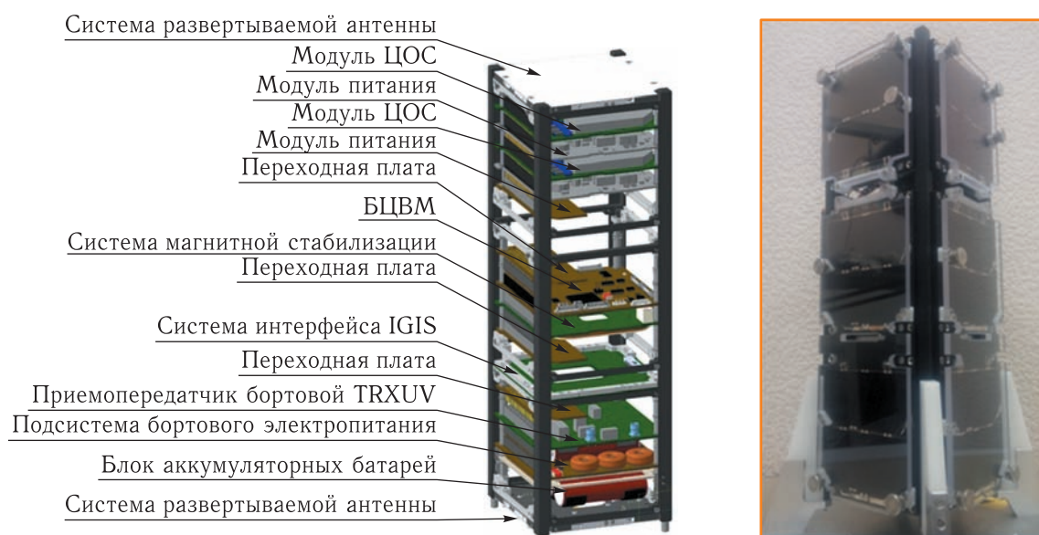
Рис. 2. Внешний вид и компоновка КА «КосмоАИС»
