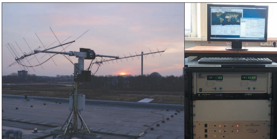
Рис. 4. Внешний вид антенно-фидерного устройства и станции приема информации с КА нанокласса «КосмоАИС»
