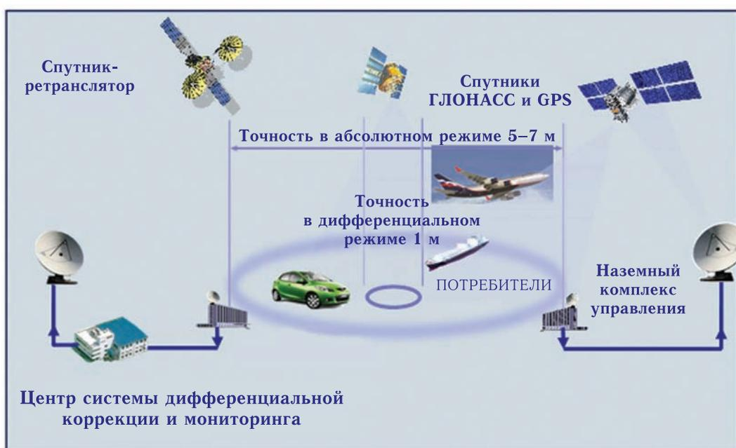
Рис. 11. Система дифференциальной коррекции и мониторинга
