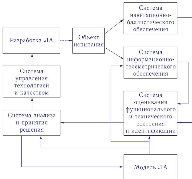
Рис. 1. Система испытания ЛА с позиций системного подхода
