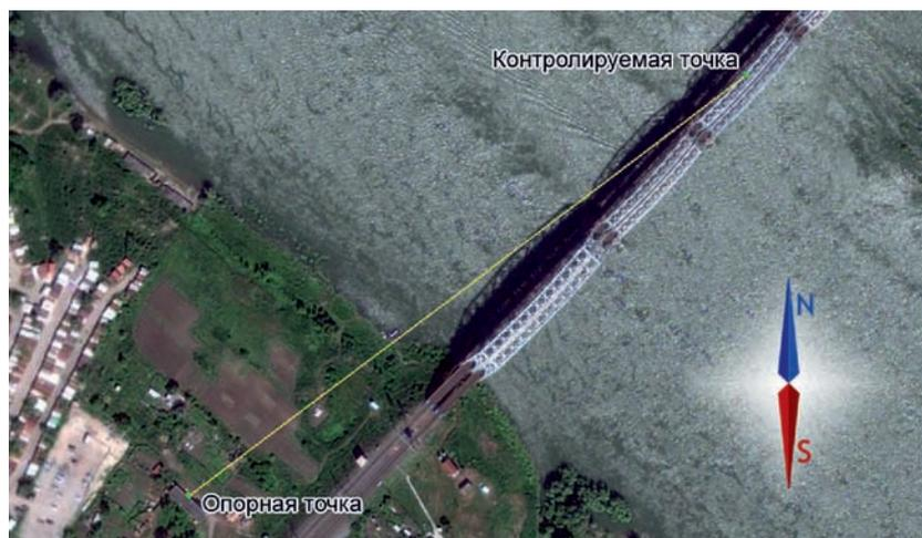
Рис. 1. Расположение измерительных модулей на железнодорожном мосту
