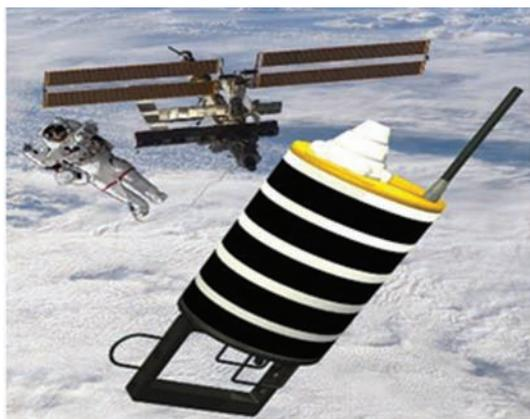
Рис. 3. Технологический наноспутник массой 4,5 кг ТНС-0
