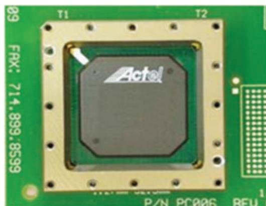
Рис. 2. Центральный модуль ИБИС (технология «система на кристалле»)
